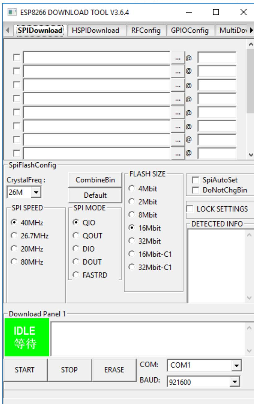
Программа будет полезна для загрузки интерпретатора JavaScript в чип ESP8266, а так же восстановить на модулях стандартную АТ-прошивку.
